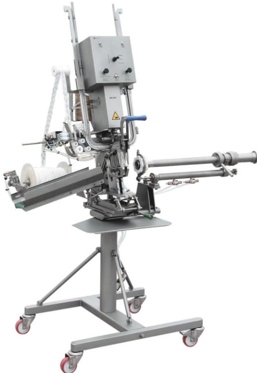
Клипсатор КН-24п предназначен для клипсования полиамидных, целлюлозных, коллагеновых оболочек и подходит для широкого спектра предприятий мясоперерабатывающей промышленности различной мощности. Главным достоинством данного клипсатора является его универсальность, простота регулировки плотности набивки батона, возможность производить на данном оборудовании штучные батоны, колбасные цепочки, а в случае укомплектования нитеподачей колбас в кольцах и полукольцах.
