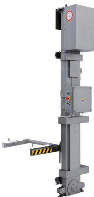
Загрузочные устройства предназначены для заполнения бункера шприца фаршем и агрегируются со шприцами «КОМПО». Благодаря своей конструкции, они занимают минимальную площадь, а также весьма просты в обслуживании и надежны в эксплуатации.
