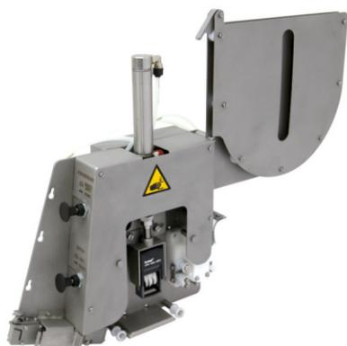
Устройство предназначено для формирования этикетки с датой из ленты этикетировочной и подачи её в зону наложения скрепки при укупоривании клипсатором батонов с различными наполнителями.
