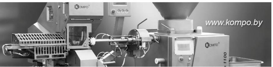
Полуавтоматический клипсатор КОМПО ПРОФИ КН-201 предназначен для изготовления колбасных батонов с использованием белковых, полиамидных, целлюлозных, фиброузных оболочек. Клипсатор позволяет выпускать колбасные изделия в диапазоне диаметров от 30 до 80 мм в виде одиночных батонов, цепочек батонов, а так же кольцевых колбас с петлей или нитью. При необходимости возможно нанесение даты производства на этикетленте, закрепленной под скрепкой.
